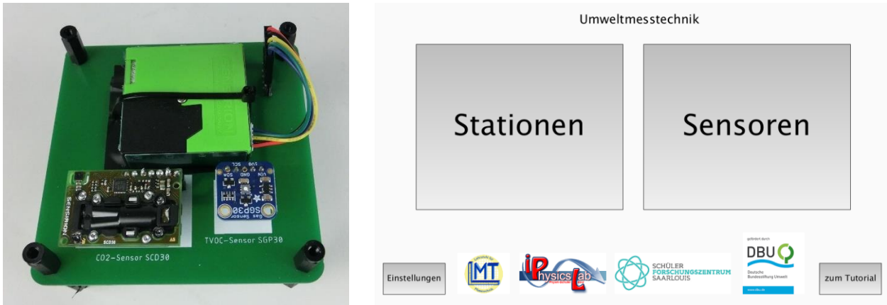
Abb. 1 Links: Messplatine mit drei Sensormodulen. Rechts: Hauptmenü der Messsoftware.
