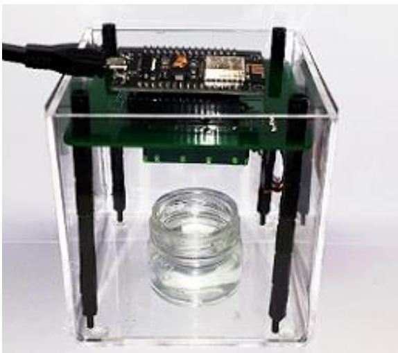
Abb. 3 Versuchsaufbau zur Messung der Ethanol-Konzentration von 5 Lösungen.
