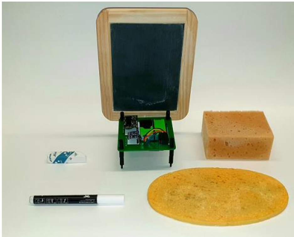
Abb. 7 Versuchsaufbau zur Untersuchung von Feinstaub in Kreide. Die Messplatine ist am unteren Rand der Tafel eingerastet.
